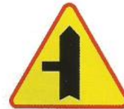
Skrzyżowanie z drogą podporządkowaną występującą po lewej stronie
